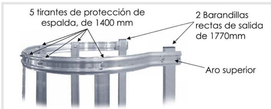
Unión aro superior a barandilla recta de salida (colocar las tuercas siempre en la parte exterior del aro)
