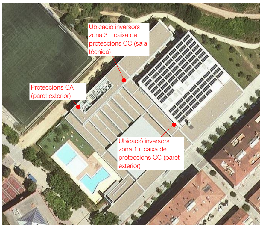
Figura 6. Situació equips elèctrics.
