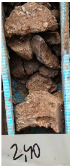
Fotografia 5. Nivell A. Argiles marro vermelloses amb nòduls carbonatats. Sondeig S- 4 a 2,2,-2,4 m de fondària.
