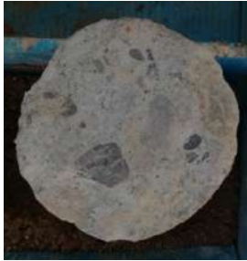
Fotografia 3. Nivell F. Formigó. Sondeig S- 4 a 0,8 m de fondària.
