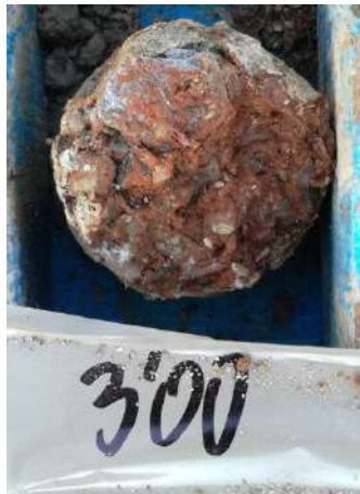
Fotografia 6. Nivell B. Graves de pissarra englobades en una matriu llimosa. Sondeig S- 1 a 3,0 m de fondària
