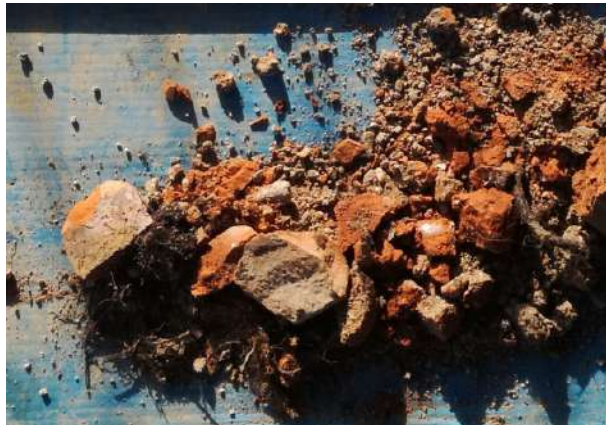
Fotografia 4. Base del nivell R2. Sondeig S- 2 a 4,35-4,45 m de fondària.
