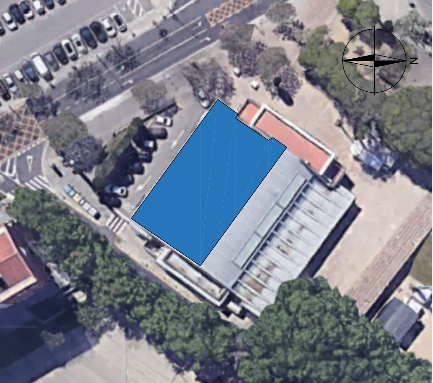
CUBIERTA UTILIZABLE ZONA SUR . AZIMUT 34º SUR-OESTE
