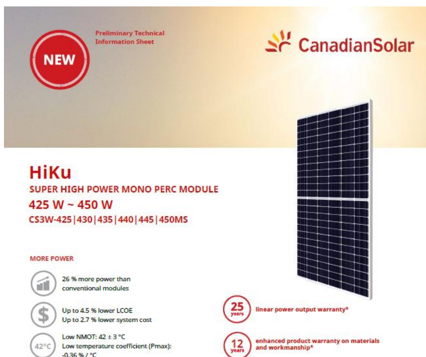
Figura 6. Características módulo fotovoltaico.
