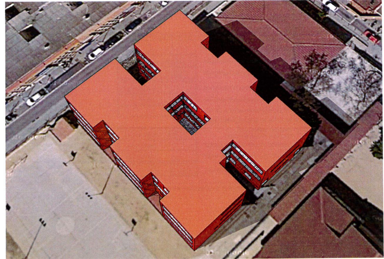
Imagen del modelado del edificio georreferenciado con el plugin para Sketchup Design-PH
